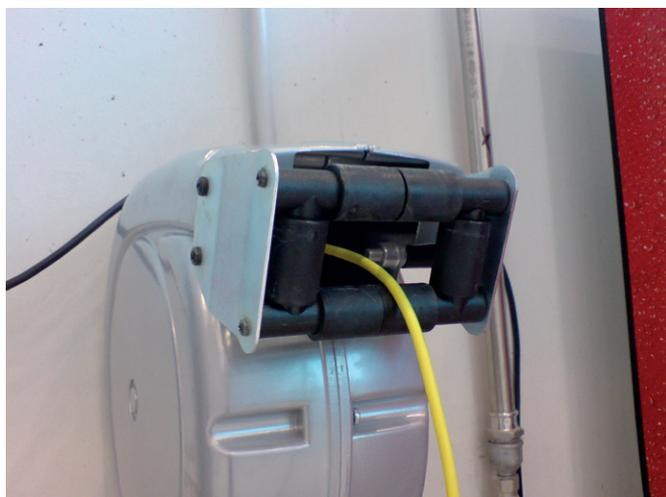
Avvolgicavo in alluminio pressofuso tipo PRC per l'equipotenziale (divere nella tecnica aeronautica).
